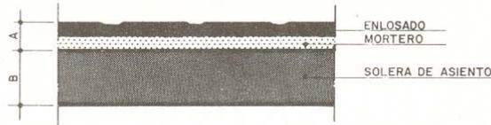
Los acerados o enlosados se componen de una solera de asiento de hormigón hidráulico o arena de miga compactada, una capa de mortero de agarre y un enlosado. Los espesores y materiales se ajustan al uso admitido. Las características se resumen en la siguiente tabla:
